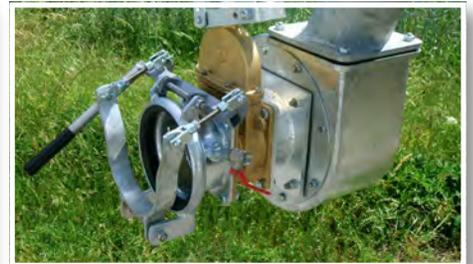
Die HJ Befüllhilfe Optimum kann auch zur Druckerhöhung an Vakuumpwagen für Schleppschläuche eingesetzt werden.
