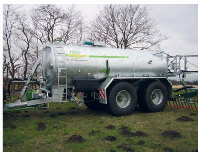
**PTWT 20**, ca. 20.000 Liter, luftgefedert, Untenanhängung K 80, 4 to Stützlast, Reifenregeldruckanlage, elektromagnetische Steuerung, zwangsgekenkt, 6.000 ltr. Drehkolbenpumpe, verstärkter Dreipunkt, uvm.
