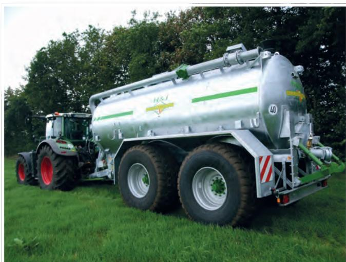
**PTWT 18**, ca. 18.000 Liter, luftgefedert, Untenanhängung K 80, 3 to Stützlast, Durchflussmesser, verstärkter Dreipunkt, zwangsgekenkt, 6.000 ltr. Drehkolbenpumpe, automatische Abschaltung, uvm.
