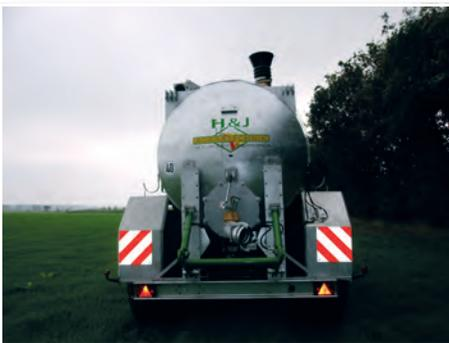
Ansaugtrichter hinten zum entnehmen der Gülle durch spezielle Ausbringfahrzeuge
