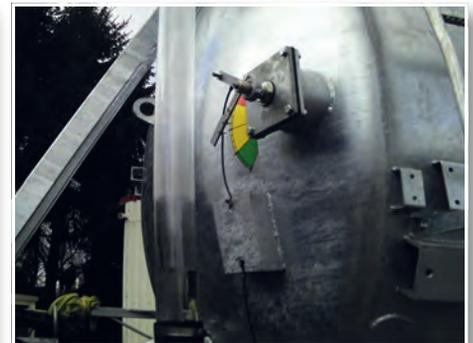
Automatische Umschaltung der Pumpe über Sensoren verhindern ein Überlaufen der Gülle beim Ansaugen
