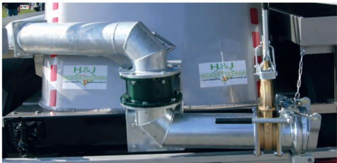
Ansaugsystem mit Drehkranz, angebaut an einem Feldbinder Gülleauflieger
