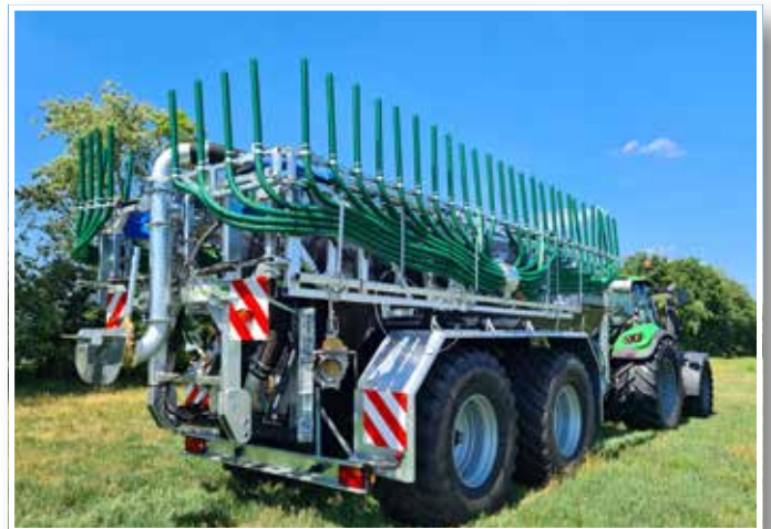
Anbau im Hubwerk des Güllewagens mit Heckklappung und integriertem Prallkopfverteiler
